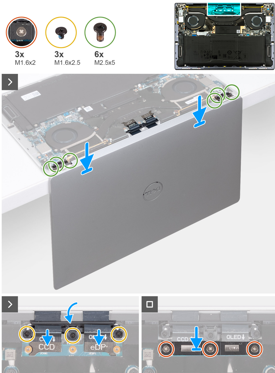
Rysunek 33. Instalowanie zestawu wyświetlacza
