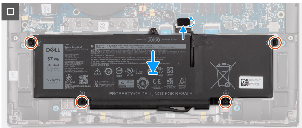
Rysunek 40. Instalowanie baterii 3-ogniowej
