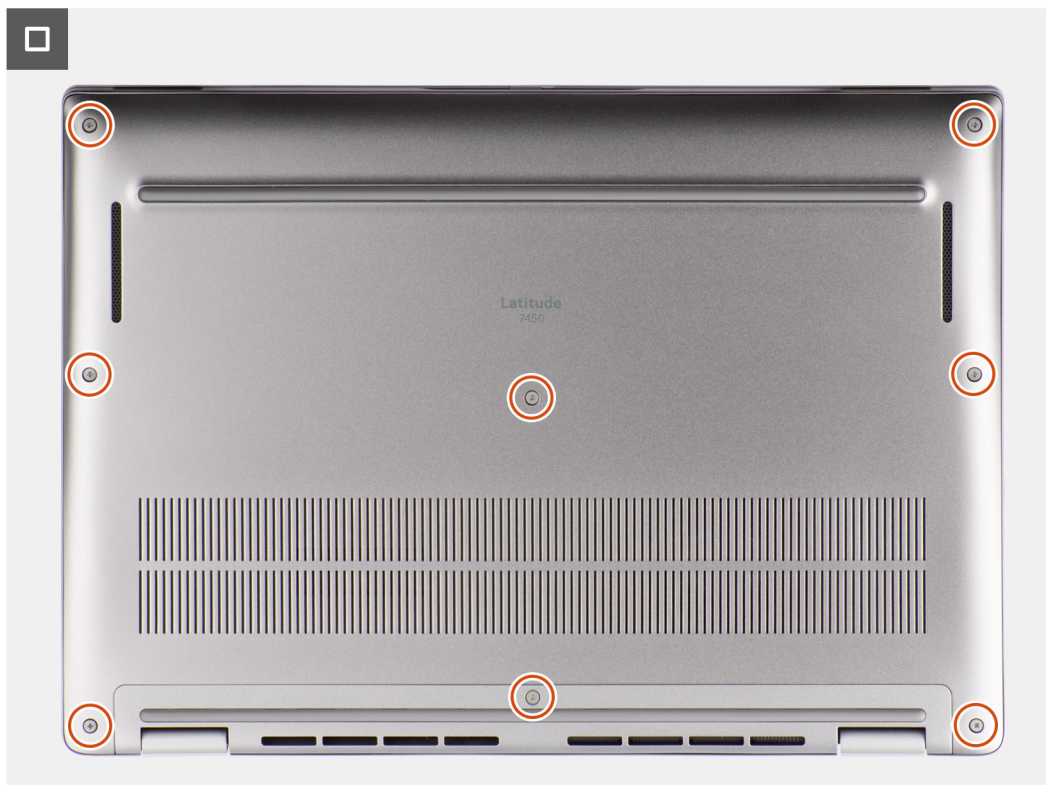
Rysunek 18. Instalowanie pokrywy dolnej
