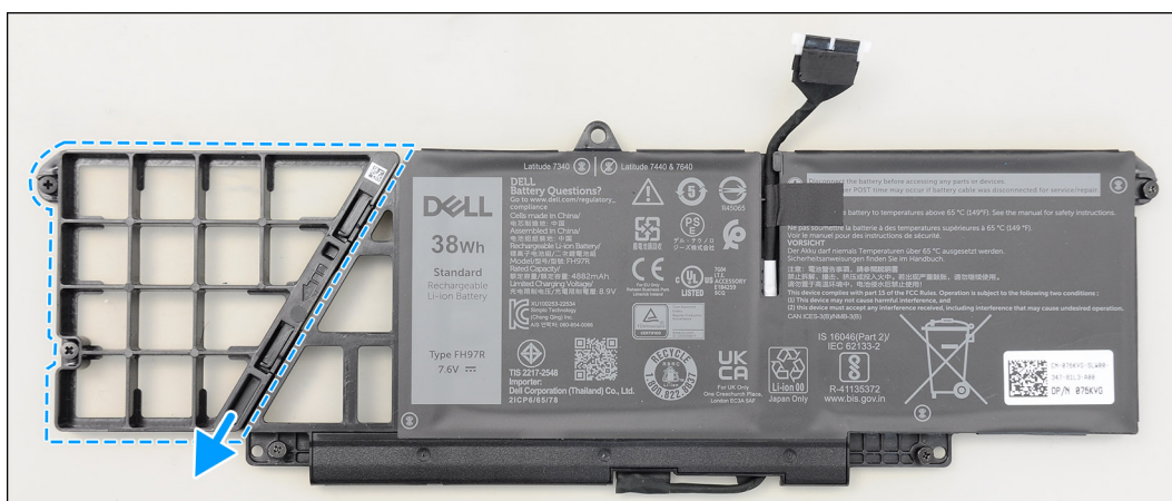
Rysunek 35. Wymontowywanie baterii 2-ogniowej
