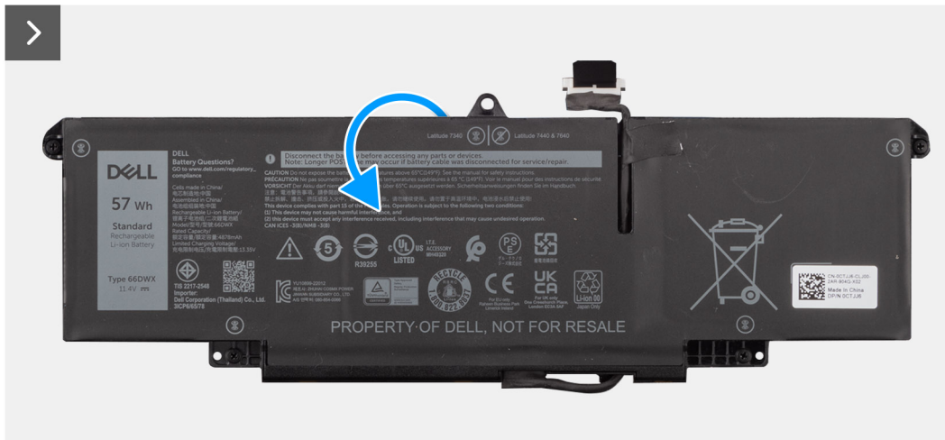
Rysunek 42. Instalowanie kabla baterii
