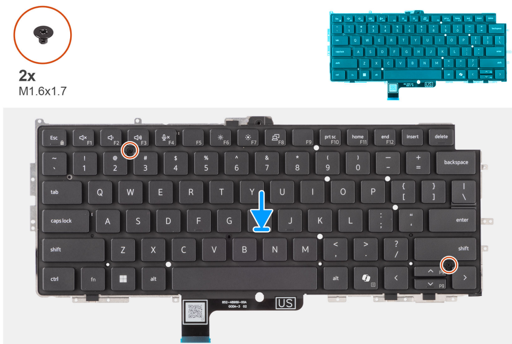
Rysunek 79. Instalowanie klawiatury
