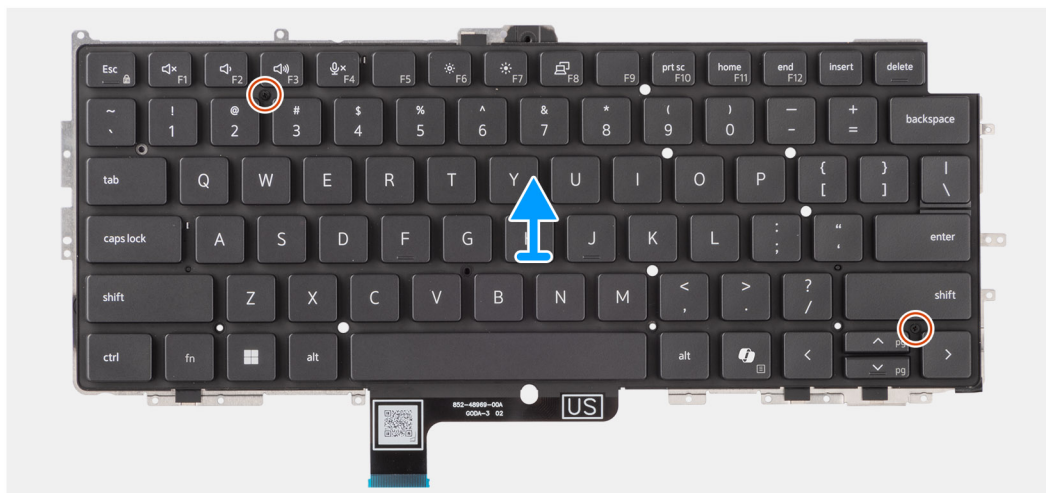
Rysunek 76. Wymontowywanie klawiatury
