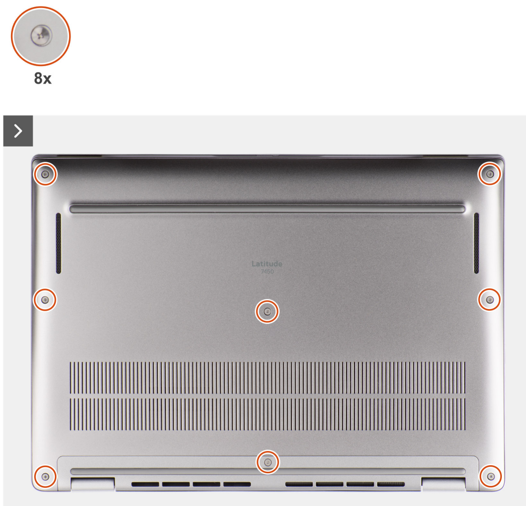
Rysunek 15. Wymontowywanie pokrywy dolnej
