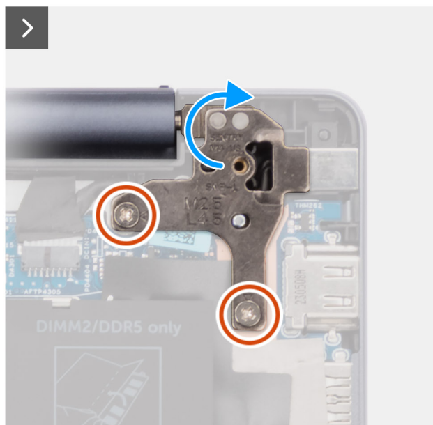
Rysunek 50. Wymontowywanie gniazda zasilacza
