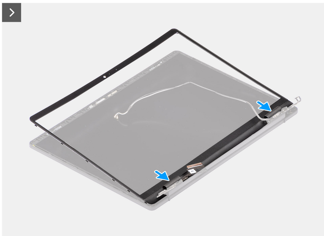
Rysunek 77. Instalowanie ramki wyświetlacza
