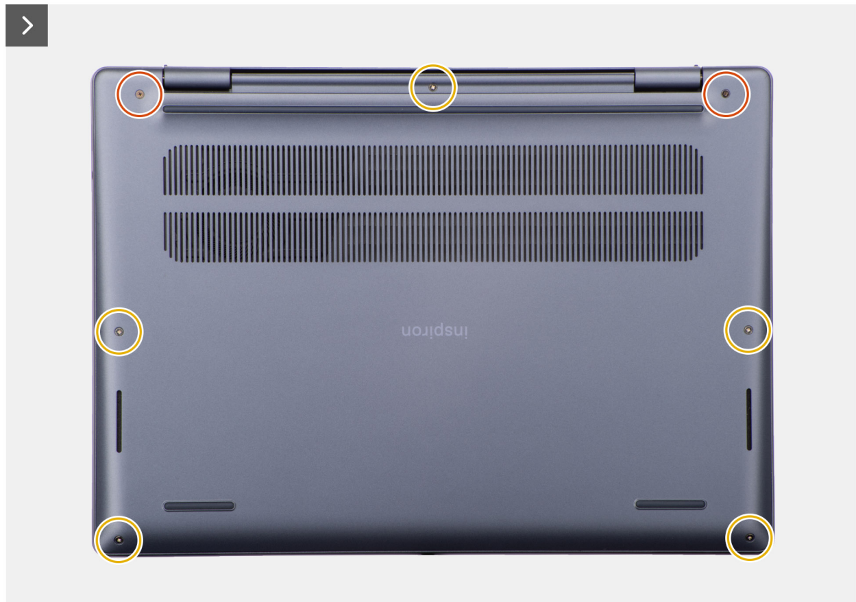
Rysunek 15. Wymontowywanie pokrywy dolnej
