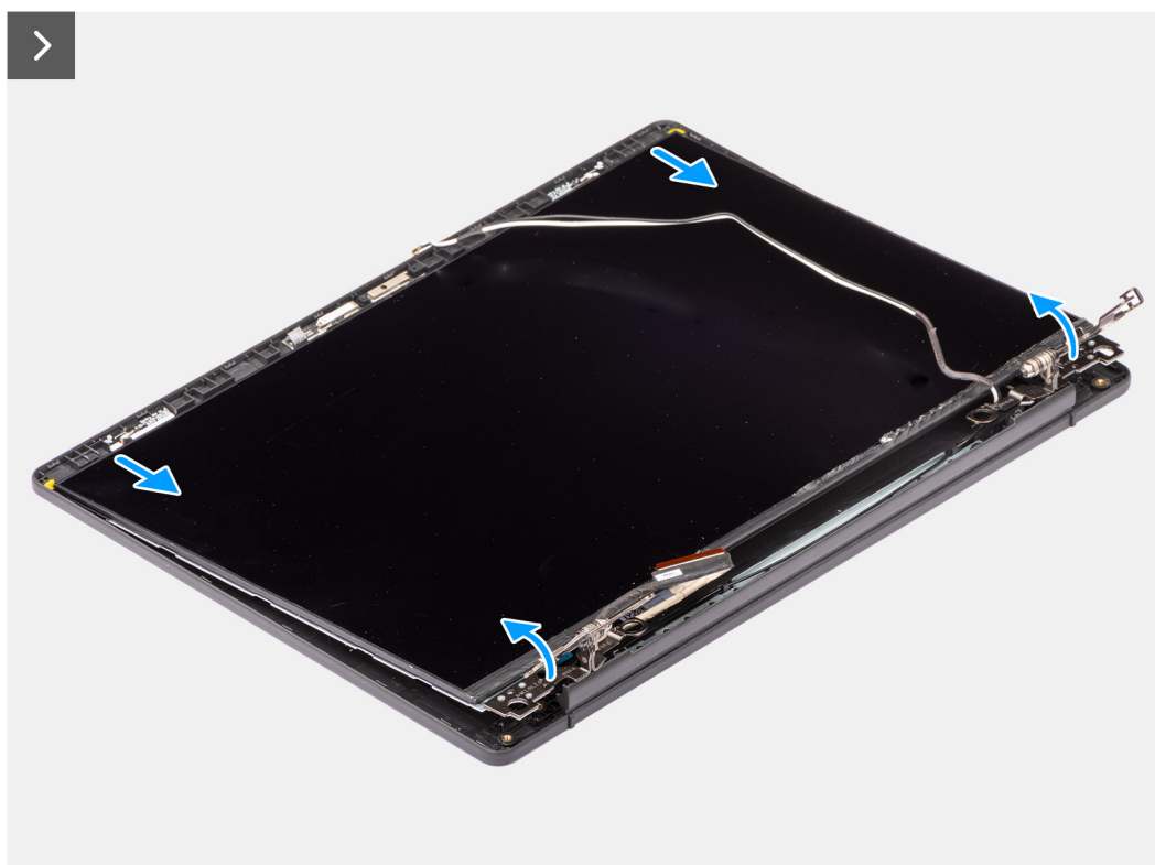
Rysunek 80. Wymontowywanie wyświetlacza
