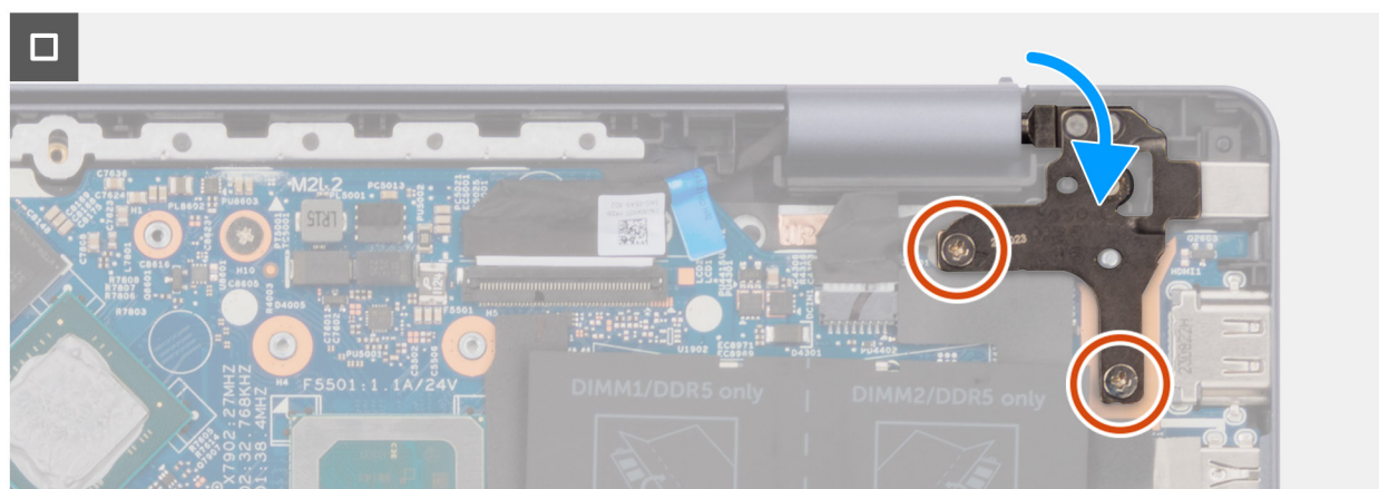
Rysunek 110. Wkręcanie śrub zawiasów
