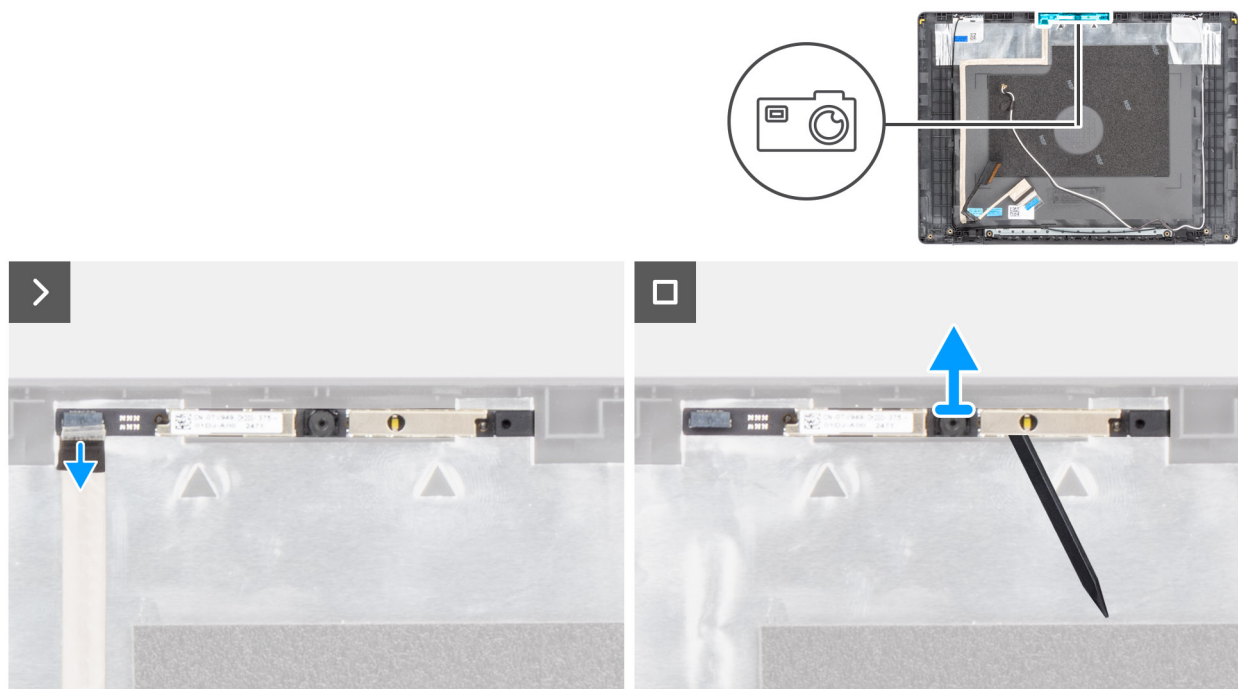
Rysunek 89. Wymontowywanie kamery
