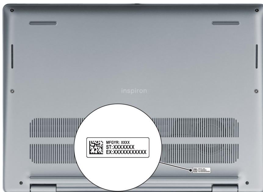
Rysunek 7. Umieszczenie kodu Service Tag
