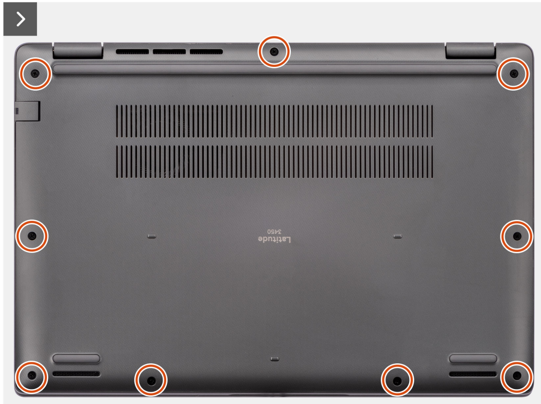
Rysunek 9. Wymontowywanie pokrywy dolnej
