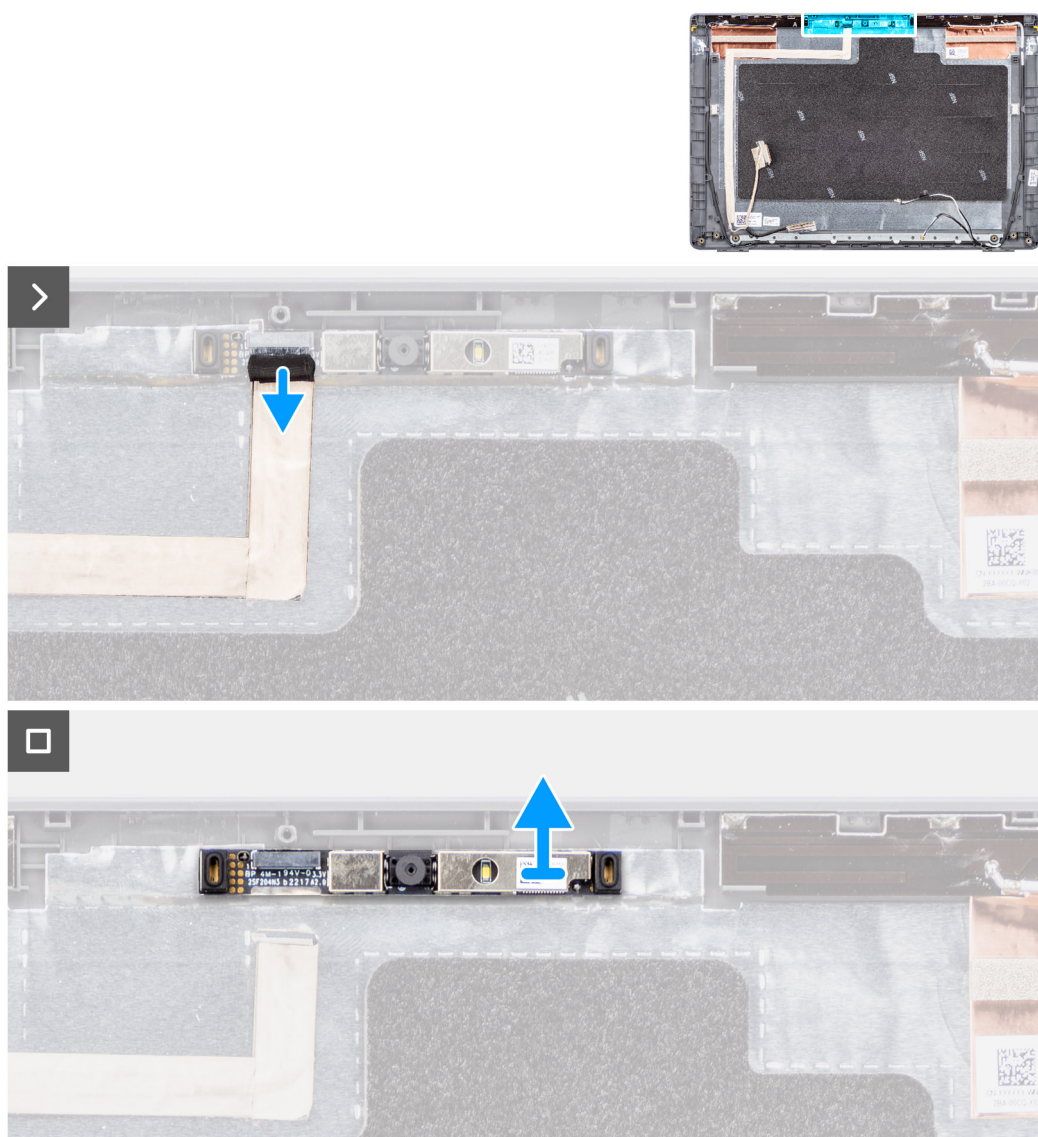
Rysunek 64. Wymontowywanie kamery
