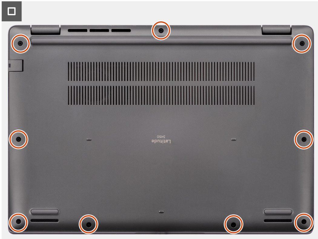
Rysunek 12. Instalowanie pokrywy dolnej
