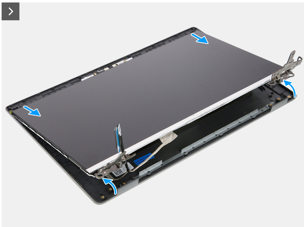
Rysunek 56. Wymontowywanie wyświetlacza
