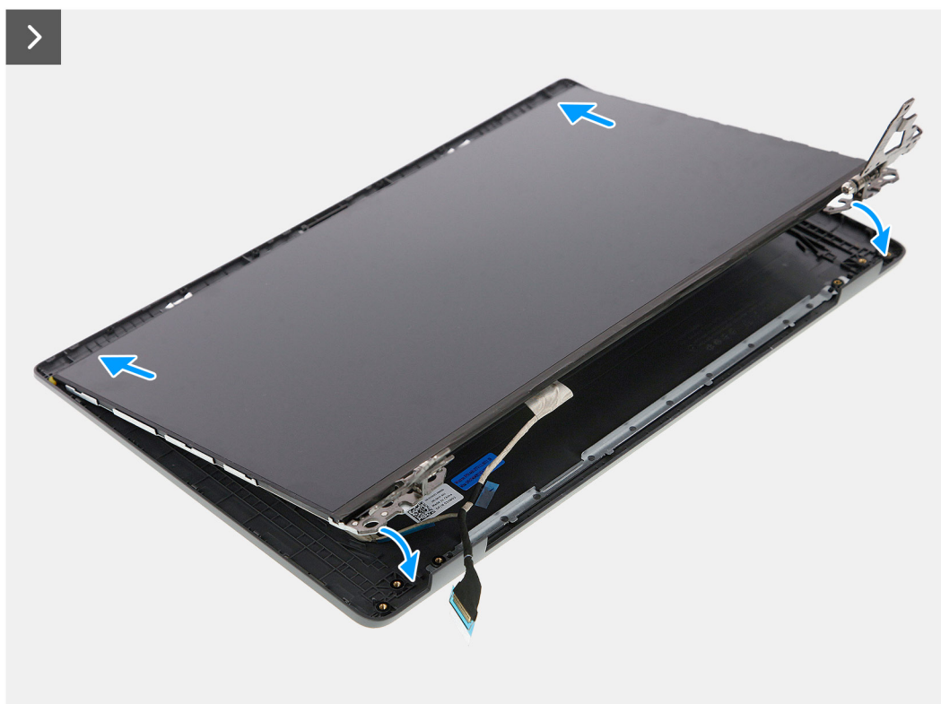
Rysunek 63. Instalowanie wyświetlacza
