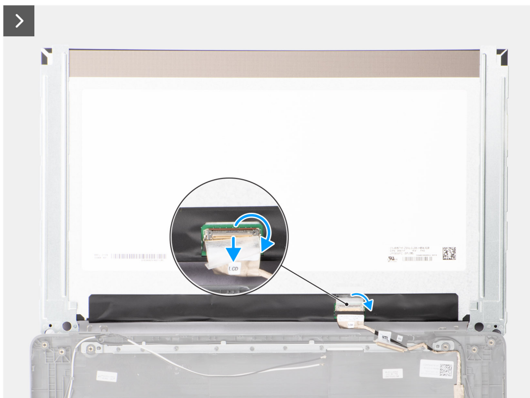
Rysunek 59. Wymontowywanie wyświetlacza
