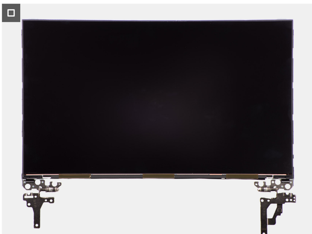
Rysunek 60. Wymontowywanie wyświetlacza
