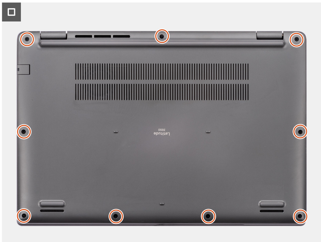
Rysunek 11. Instalowanie pokrywy dolnej
