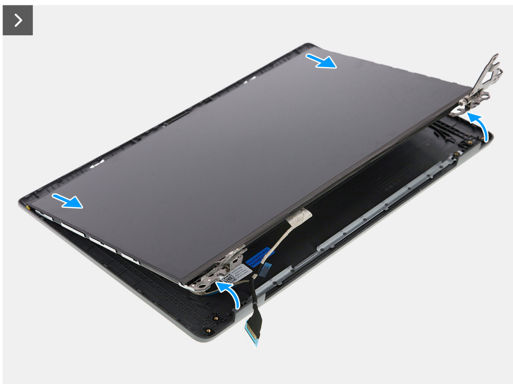
Rysunek 58. Wymontowywanie wyświetlacza
