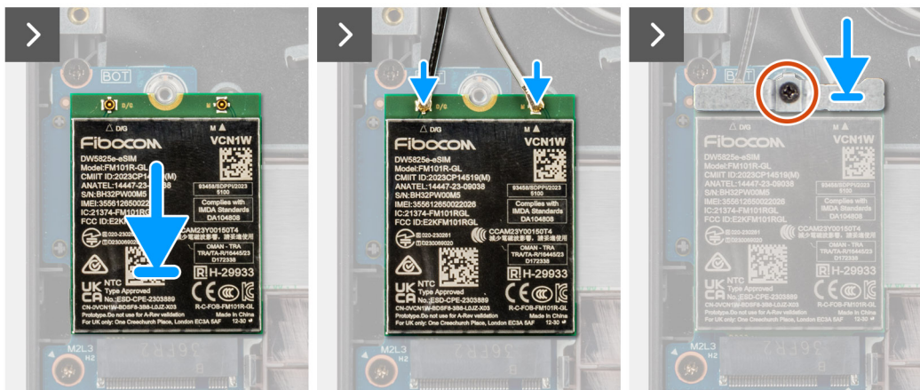
Rysunek 17. Instalowanie karty sieci WWAN
