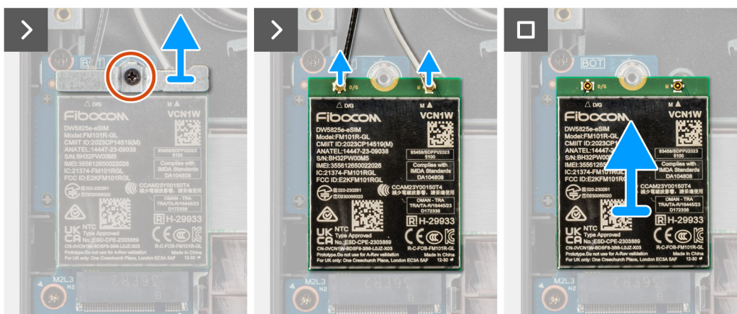
Rysunek 16. Wymontowywanie karty sieci WWAN
