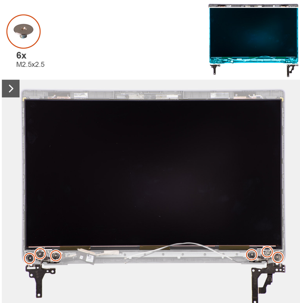
Rysunek 56. Wymontowywanie wyświetlacza
