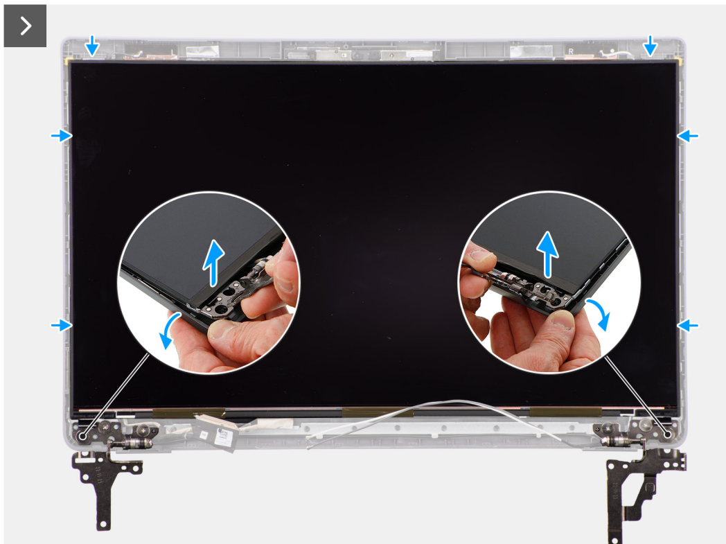
Rysunek 57. Wymontowywanie wyświetlacza
