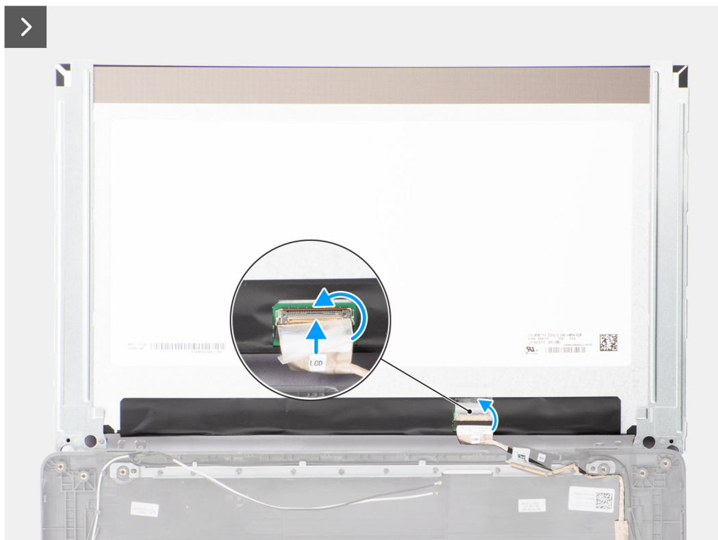
Rysunek 62. Instalowanie wyświetlacza
