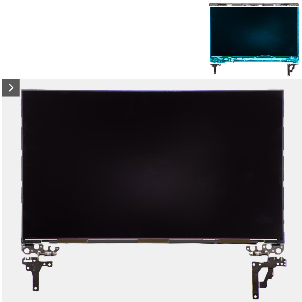
Rysunek 61. Instalowanie wyświetlacza
