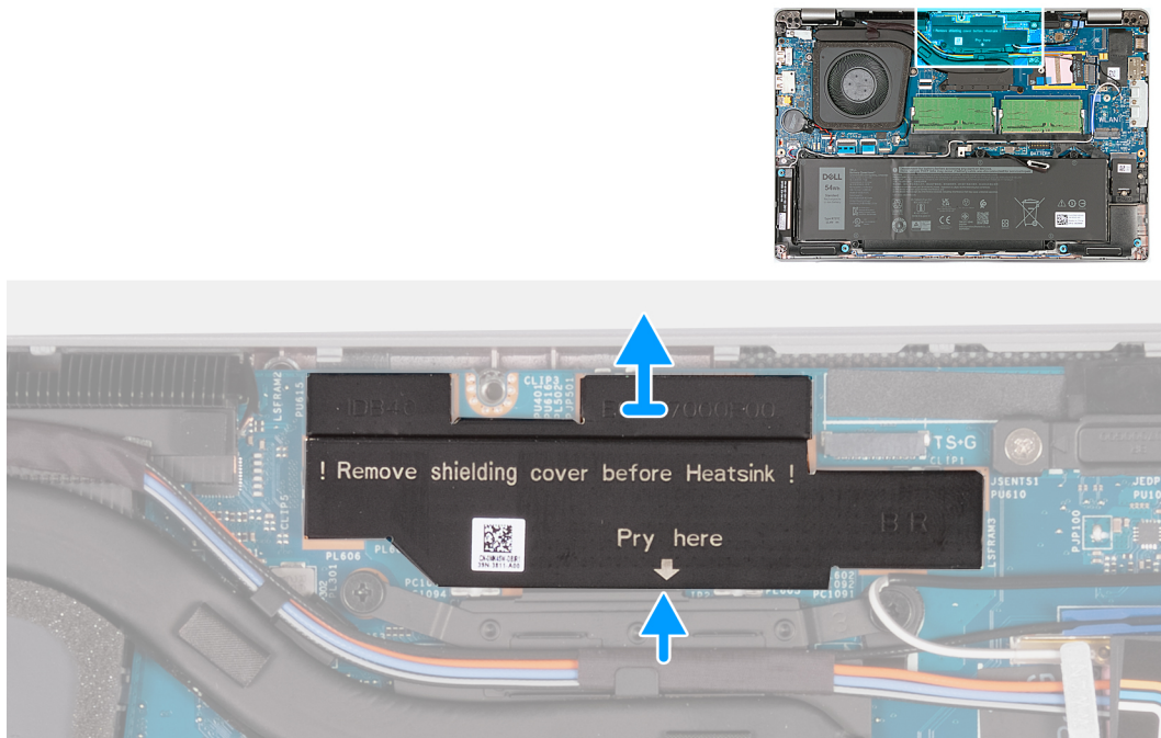
Rysunek 31. Wymontowywanie osłony zasilacza — dotyczy komputerów wyposażonych w płytę główną H28 UMA
