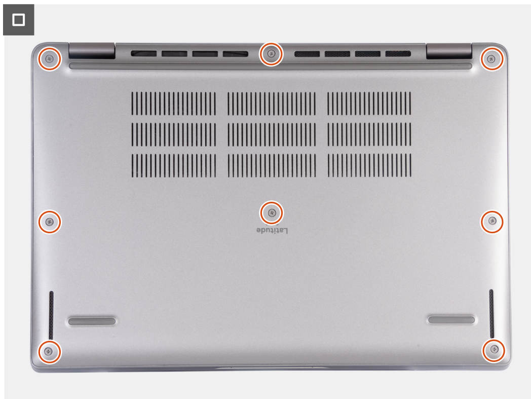
Rysunek 22. Dokręcanie ośmiu śrub mocujących pokrywę dolną do zestawu podpórki na nadgarstek
