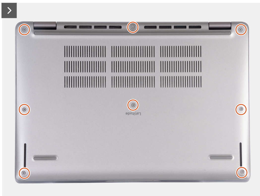
Rysunek 17. Luzowanie ośmiu śrub mocujących pokrywę dolną do zestawu podpórki na nadgarstek
