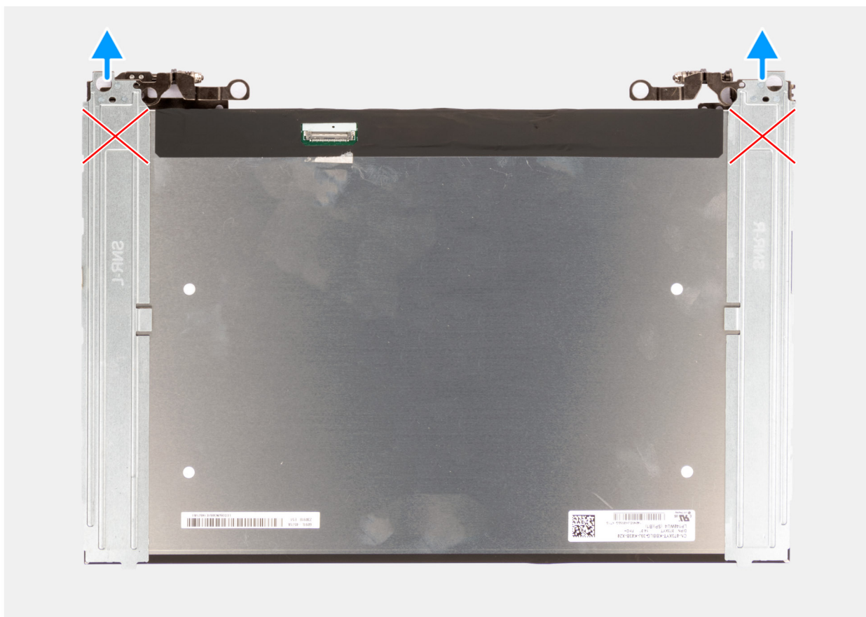
Rysunek 57. Wymontowywanie wyświetlacza
