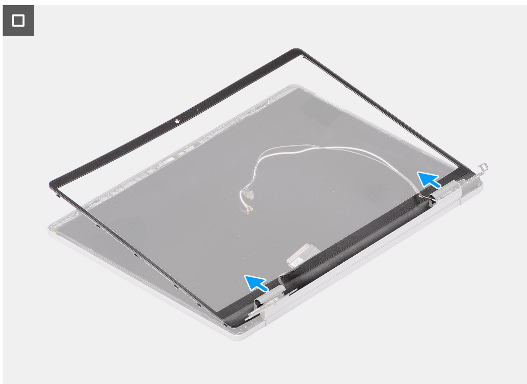
Rysunek 49. Wymontowywanie ramki wyświetlacza
