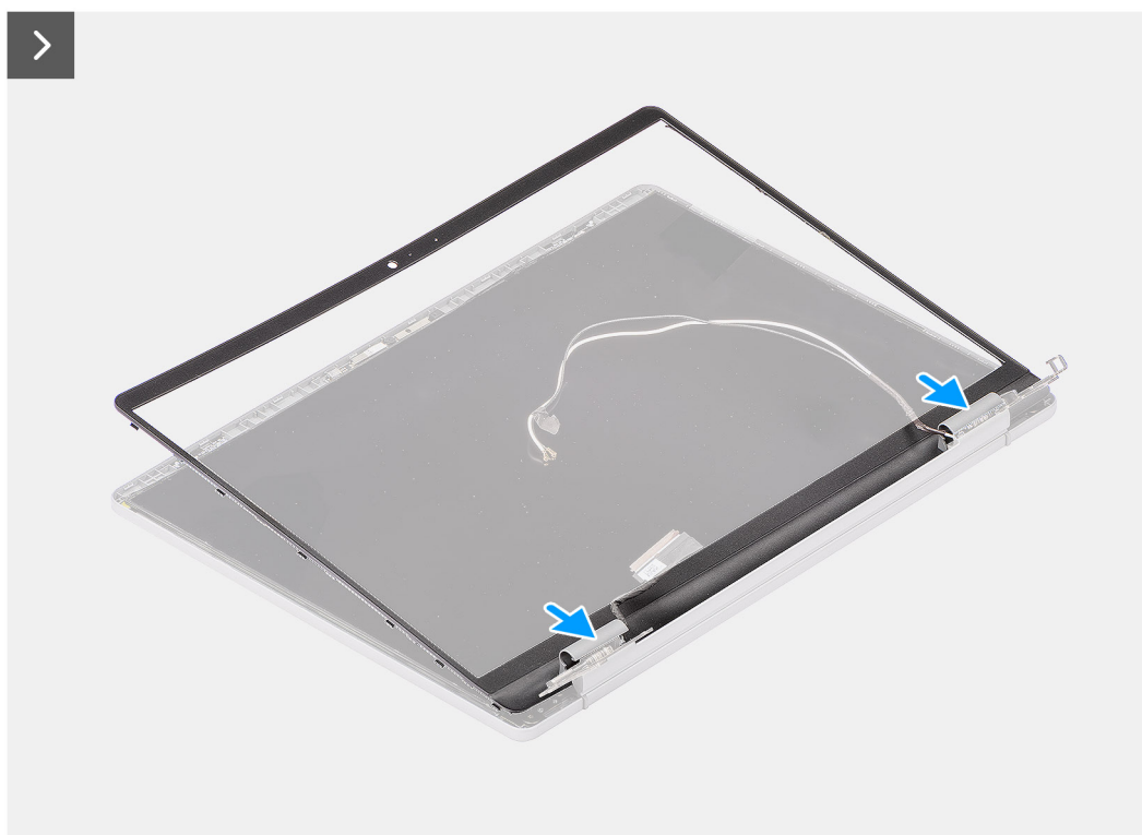
Rysunek 51. Instalowanie ramki wyświetlacza
