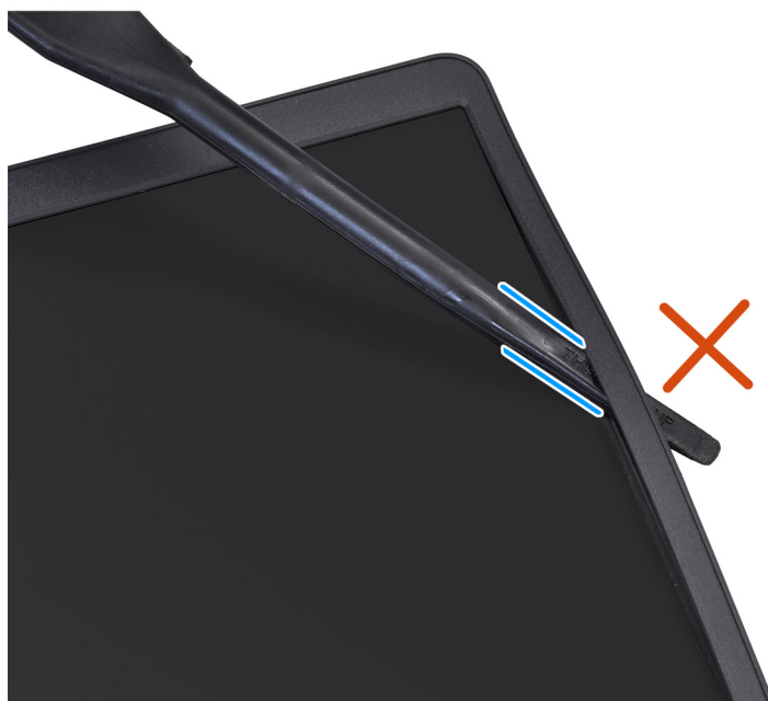
Rysunek 50. Wymontowywanie ramki wyświetlacza
