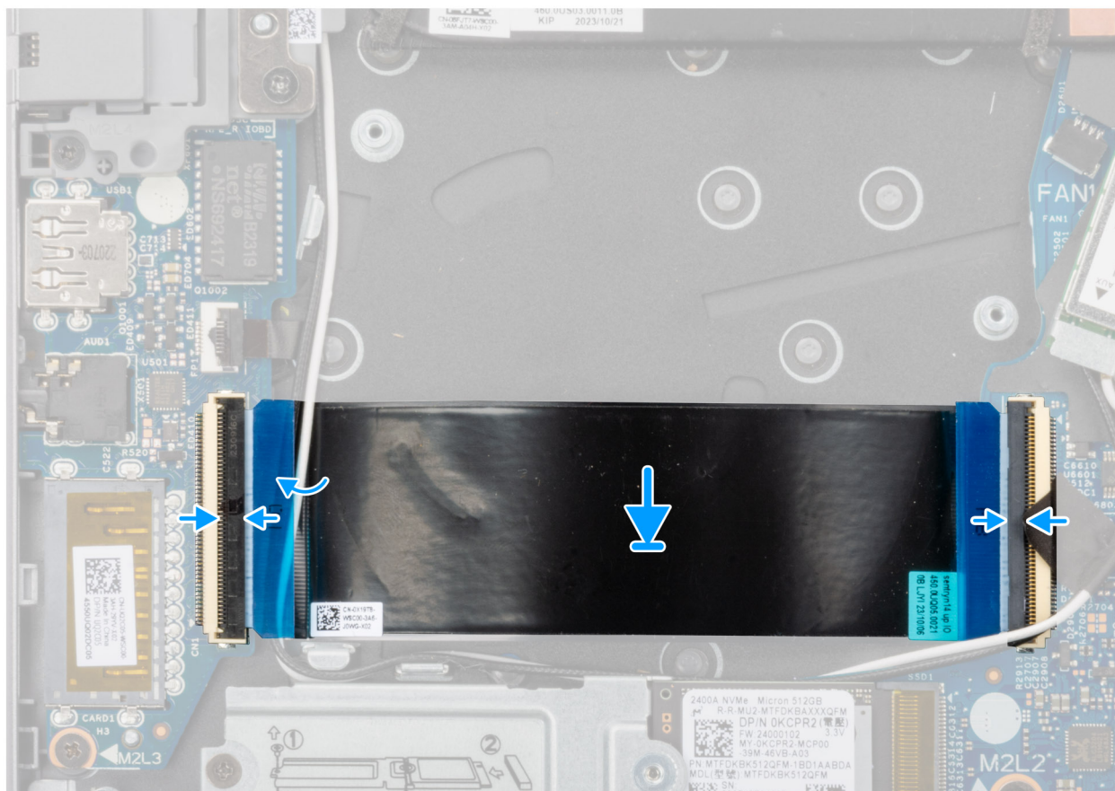
Rysunek 35. Instalowanie kabla płyty we/wy
