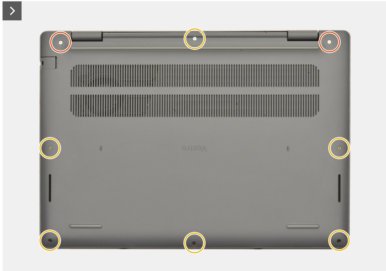
Rysunek 10. Wymontowywanie pokrywy dolnej
