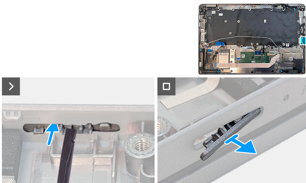
Rysunek 65. Wymontowywanie zaślepki gniazda karty SIM
