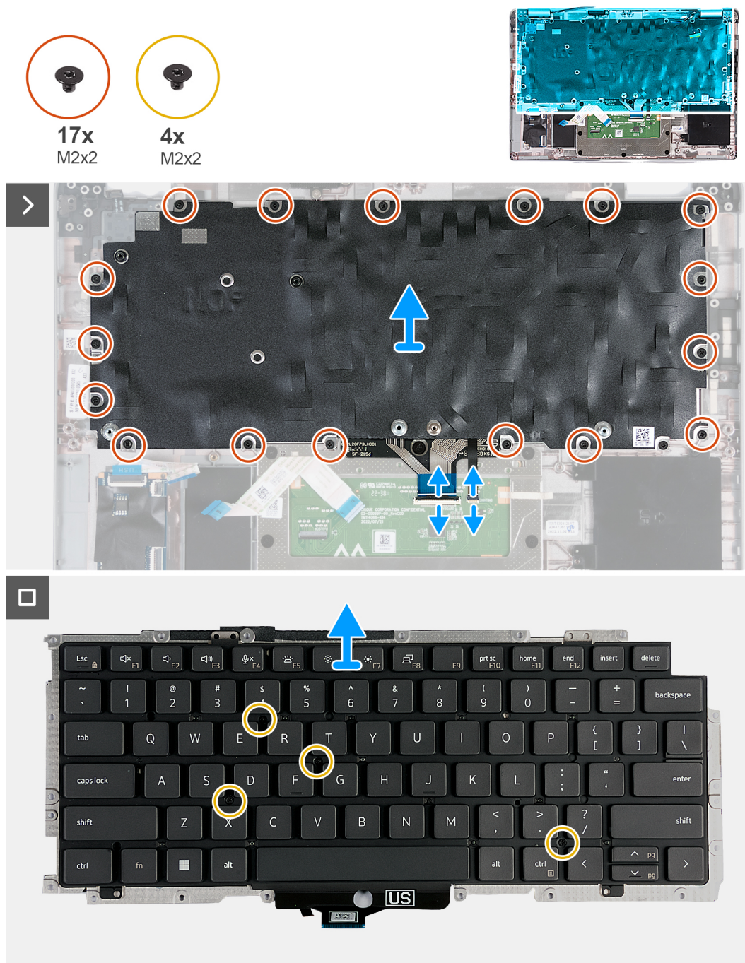
Rysunek 61. Wymontowywanie klawiatury
