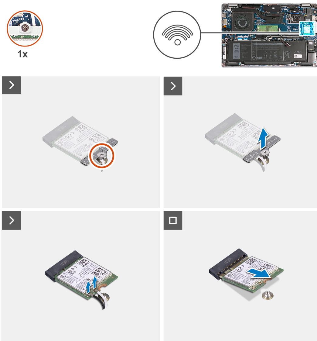
Rysunek 10. Wymontowywanie karty sieci bezprzewodowej
